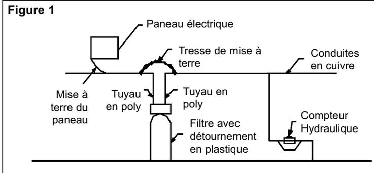
A tout endroit où la tuyauterie en métal originale se fait interrompre par des tuyaux en poly ou par une soupape de dérivation Noryl telle qu'à la figure 1, ou par une séparation physique telle qu'à la figure 2, pour assurer la métallisation adéquate des tuyaux, une tresse de mise à la terre en cuivre à un niveau de conductivité d'au moins 6 doit être installée pour assurer la continuité du courant.
